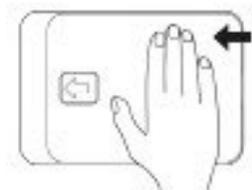
Ouvrez le cache-piles en le faisant coulisser dans le sens de la flèche.
