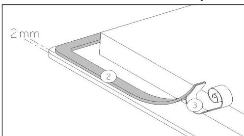
Poista tiivistelistan suojaripperi (3) ja kiinnitä lista (2) 2mm:n etäisyydelle lasin ulkoreunasta.
